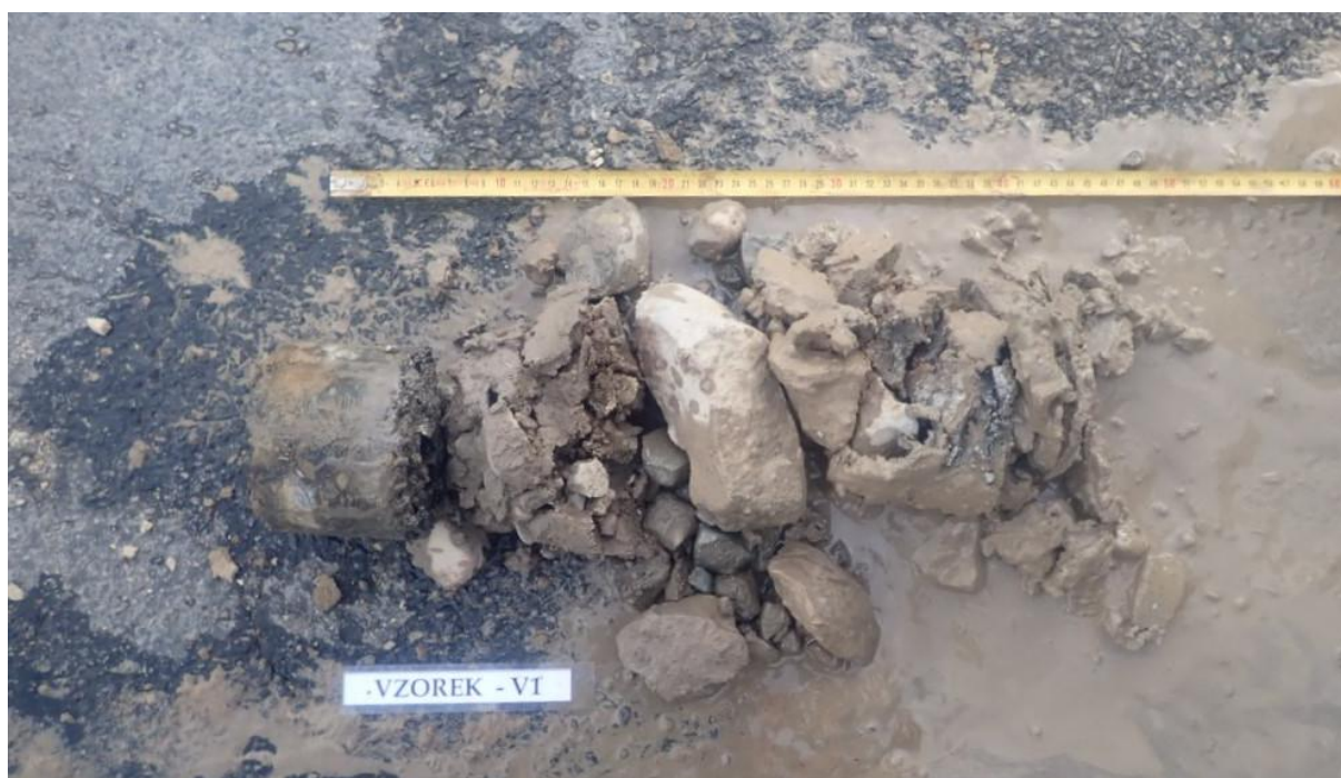
Obr. 1 - Jádro vývrtu Vzorek – V1 (in situ).
