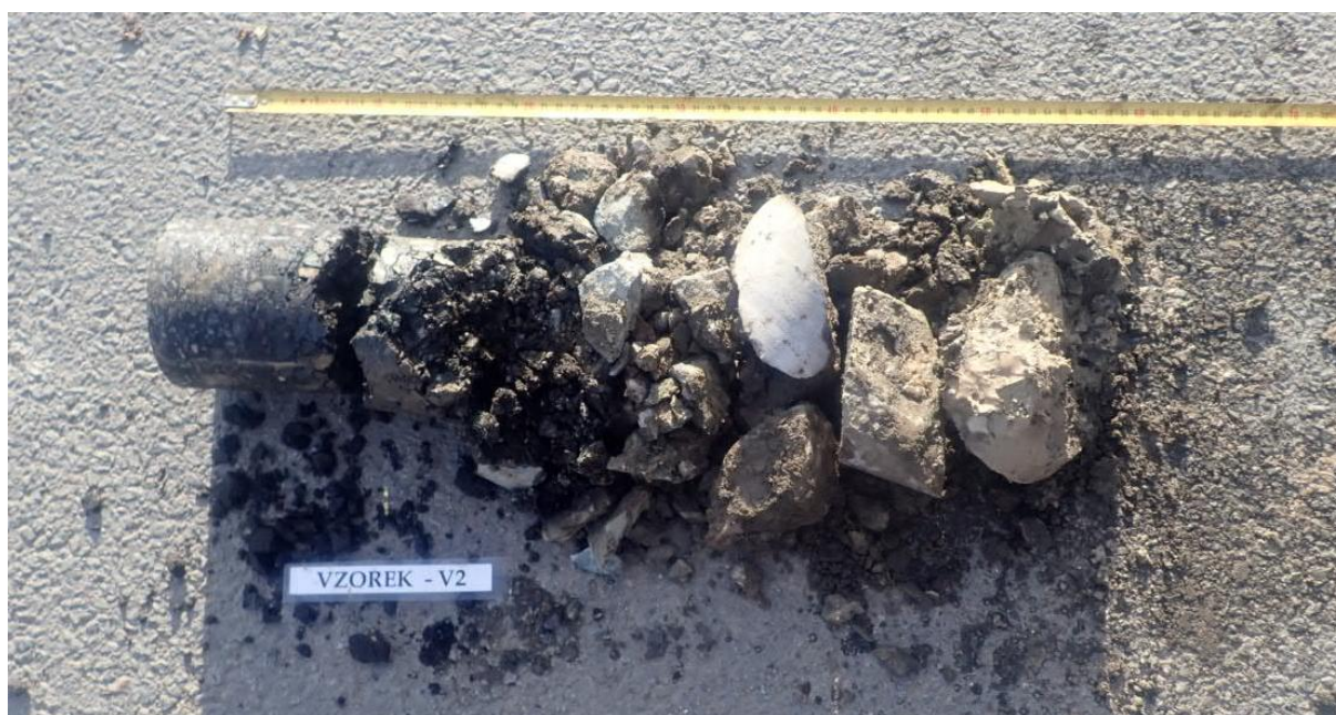
Obr. 3 - Jádro vývrtu Vzorek – V2 (in situ).
