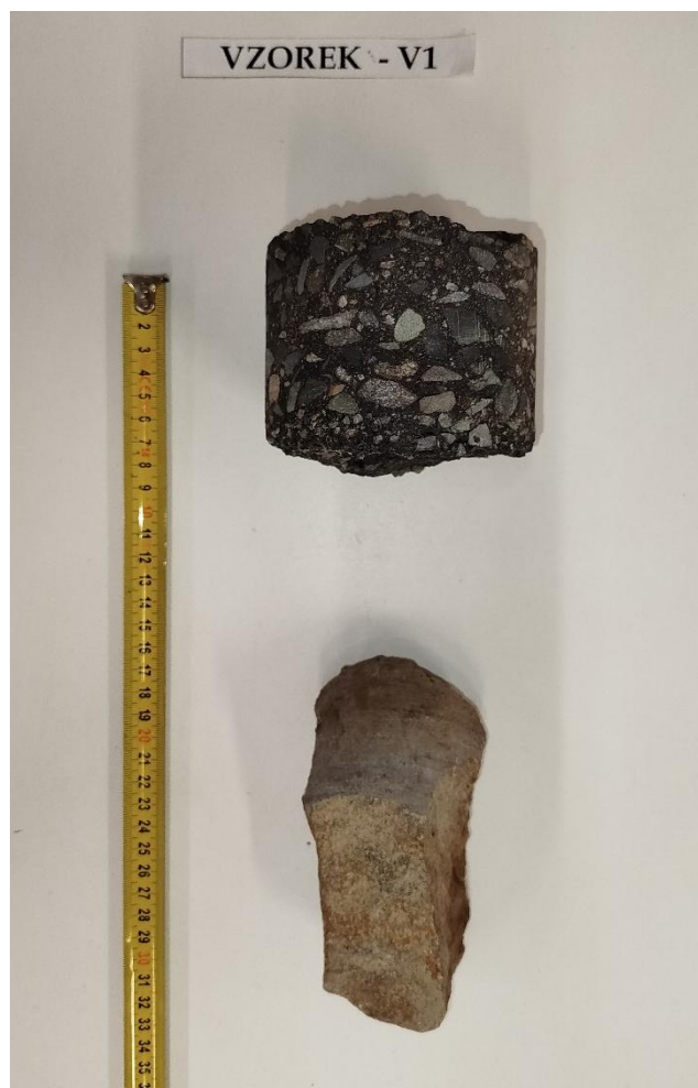
Obr. 2 - Jádru vývrtnu Vzorek – V1 (laboratoř).
