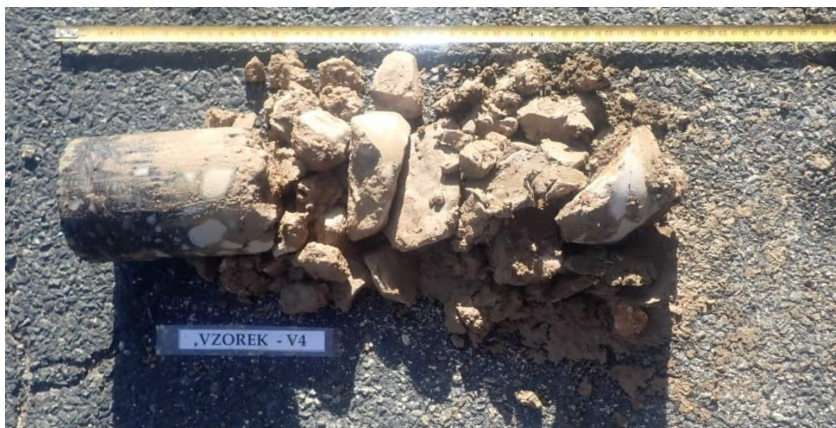
Obr. 7- Jádro vývrtu Vzorek – V4 (in situ).
