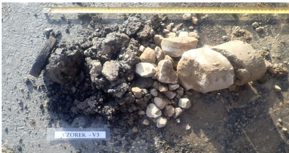
Obr. 5 - Jádro vývrtu Vzorek – V3 (in situ).
